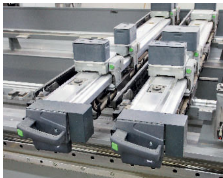
/ Die Rover ist mit „EPS“ (Electronic Positioning System) ausgestattet: Traversen und Sauger werden dabei vollautomatisch und exakt positioniert.
