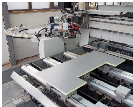
Auf der Rover B Edge 1950 lassen sich Teile komplett in einer Aufspannung bearbeiten und inklusive Innen- und Außenradien fertig bekanten.
