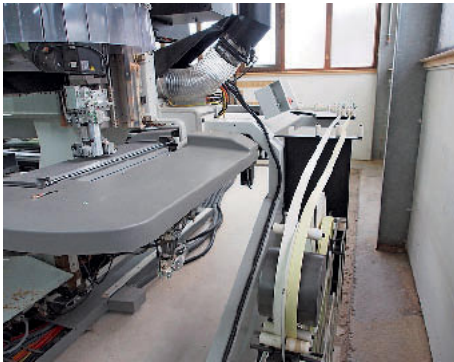
Das Kantenmagazin hinter der Bearbeitungseinheit bietet Platz für zwei Rollen. Von hier aus wird die angewählte Kante der Bearbeitung zugeführt.
