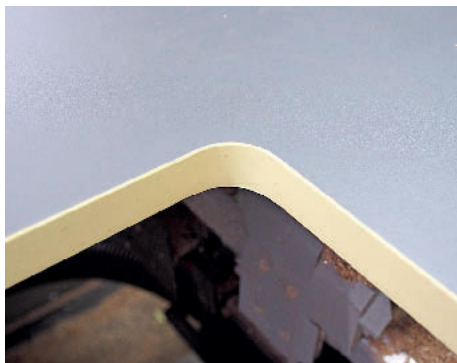
/ Auch enge Kurven kein Problem: Dieses Möbelteil wurde mit einem Innenradius von lediglich 18 mm komplett bearbeitet und bekantet.
