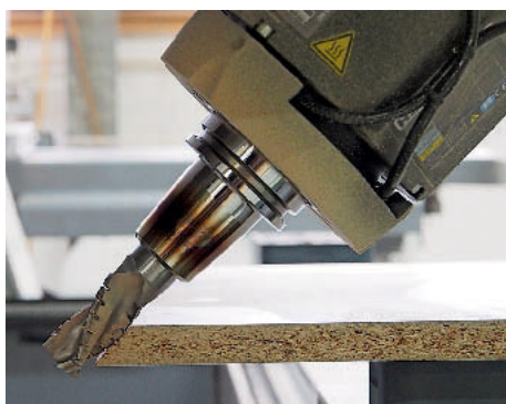
/ Die Biesse-Fünfachsspindel hat eine Leistung von 13 kW, die C-Achse ist 360° endlos drehbar. Der Kettenwechsler bietet Platz für 33 Werkzeuge.
